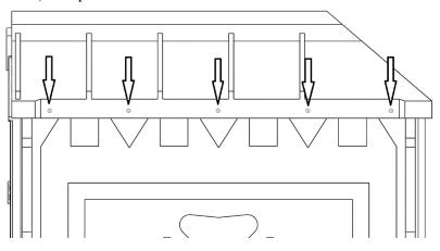
3.21. Просверлить отверстия в двери и закрепить вытяжными заклепками (4,8х16 мм) проушину для замка. Вторую проушину закрепить таким же образом на арке:
