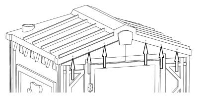
3.20. Просверлить 15 отверстий в крыше и трех боковых панелях (по 5 отверстий на каждую сторону), ориентируясь на специальные ребра жесткости, и закрепить крышу вытяжными заклепками (4,8х16 мм) в паре с шайбами:
