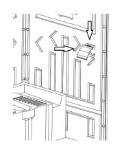
3.13. На внутренней стороне передней лицевой панели, просверлить отверстия для закрепления задвижки (на специальной площадке) и крючка для одежды (на арке). Заклепать крючок и задвижку вытяжными заклепками (4,8х16 мм):
