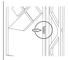
3.22. Вытяжную трубу поднять до упора в крыше и закрепить ее шурупом через специальный кронштейн в баке:
