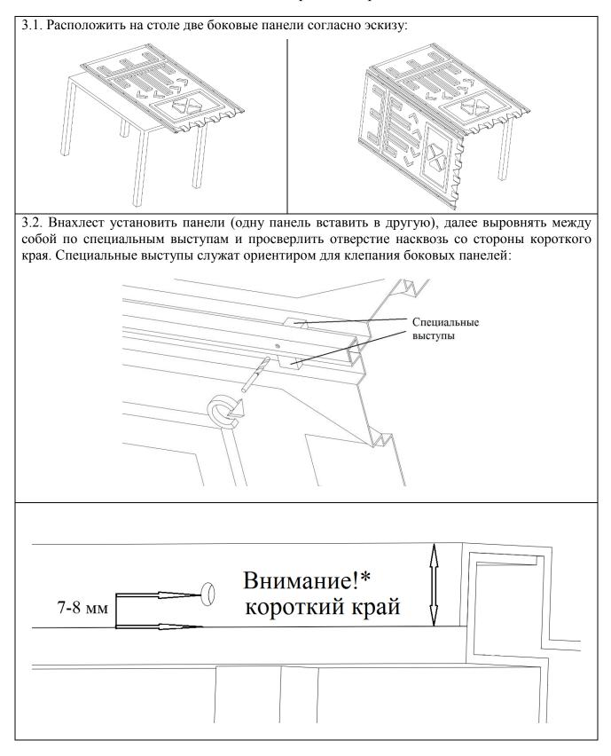
3.3. В просверленное отверстие вставить лепестковую заклепку (4,8х18 мм) и заклепать:
