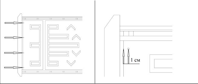
3.7. Закрепить деревянный поддон к трем панелям при помощи 12 шестигранных шурупов в паре с шайбой:
