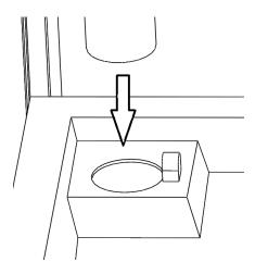
3.12. Просверлить два отверстия диаметром 5 мм в бумагодержателе и боковой панели. Закрепить бумагодержатель в удобном месте на боковой панели с помощью вытяжных заклепок (4,8х16 мм):
